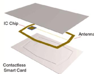
Componentes internos de una tarjeta inteligente sin contactos (contactless Smart card) Mifare. Se trata de una pequeña computadora con comunicación inalámbrica, que se encuentra incrustada dentro del cuerpo de una tarjeta plástica. En ella el FS26 puede escribir y leer información de manera inalámbrica.
